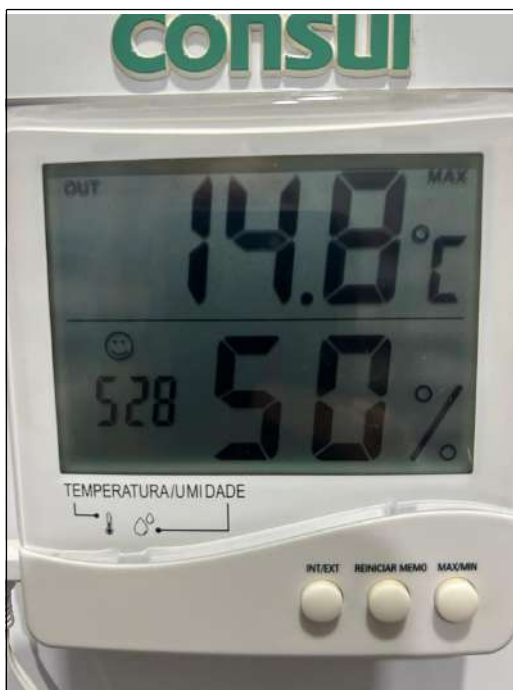
Farmácia - Termômetro do refrigerador indicando temperatura máxima acima do permitido
